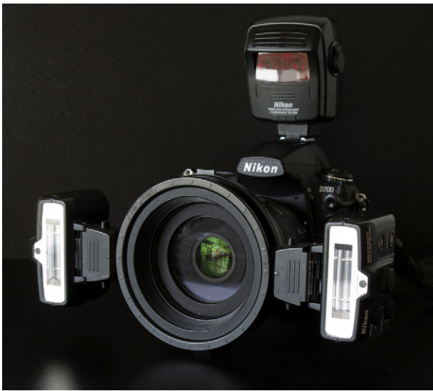
Figura 2 Cámara réflex con objetivo macro y flash anular acoplado.
